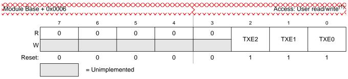
Figure 8-10. MSCAN Transmitter Flag Register (CANTFLG)
