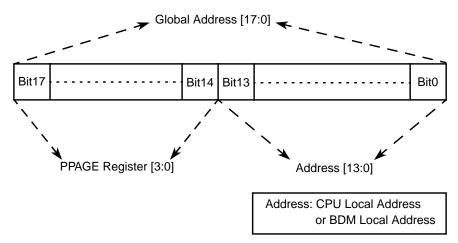
Figure 3-8. PPAGE Address Mapping
