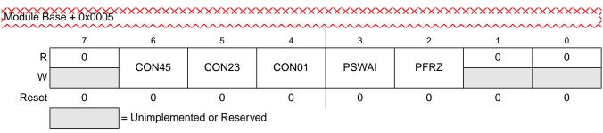
Figure 10-8. PWM Control Register (PWMCTL)
