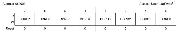
Figure 2-4. Port B Data Direction Register (DDRB)
