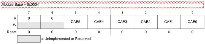
Figure 10-7. PWM Center Align Enable Register (PWMCAE)
