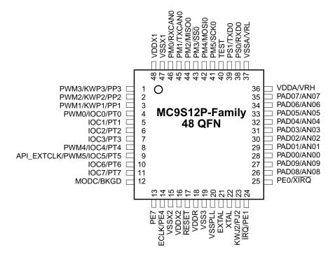
Figure 1-5. MC9S12P-Family 48 QFN pinout
