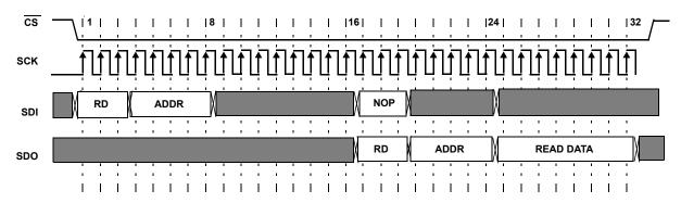
FIGURE 28. FOUR BYTE READ SEQUENCE
