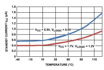
FIGURE 24. STANDBY CURRENT vs TEMPERATURE
