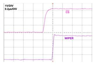
FIGURE 21. WIPER LARGE SIGNAL SETTLING TIME
