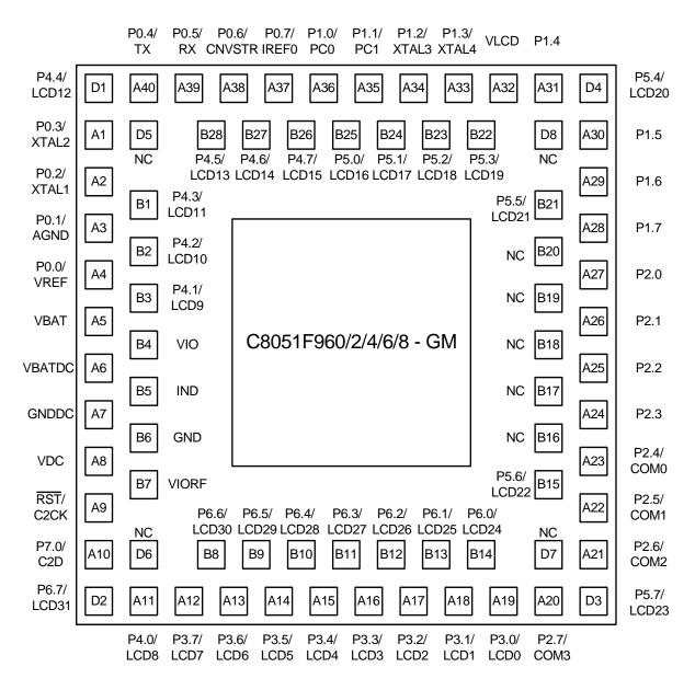
Figure 3.1. DQFN-76 Pinout Diagram (Top View)
