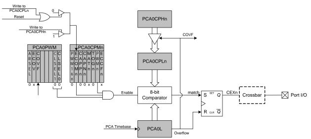
Figure 33.8. PCA 8-Bit PWM Mode Diagram
