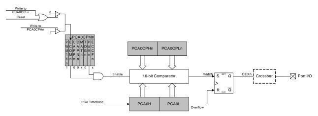
Figure 33.10. PCA 16-Bit PWM Mode
