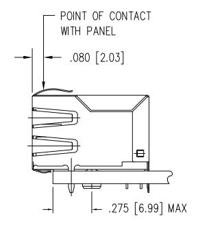
THE SUGGESTED PANEL OPENING IS INTENDED TO GIVE THE USER THE ABILITY TO HAVE REASONABLE JACK / PANEL CLEARANCES YET MAINTAIN RELIABLE GROUNDING CAPABILITY.
