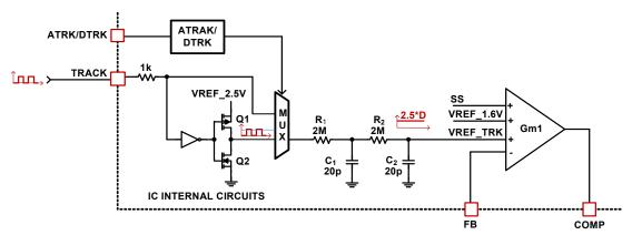
FIGURE 51. TRACK FUNCTION BLOCK DIAGRAM
