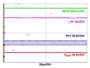
FIGURE 25. STEADY-STATE OPERATION OF INPUT CONSTANT CURRENT MODE,  $I_{\text{IN}}$  CONTROLLED AT 43A CONSTANT,  $V_{\text{OUT}}$  = 19.5V
