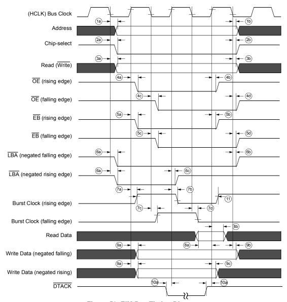
Figure 53. EIM Bus Timing Diagram
