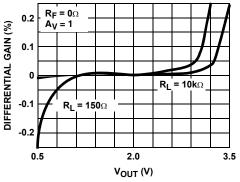
FIGURE 27. DIFFERENTIAL GAIN FOR  $\rm R_L$  TIED TO 2.5V
