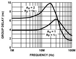
FIGURE 10. GROUP DELAY vs FREQUENCY
