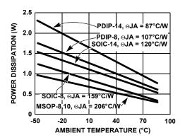
FIGURE 46. MAXIMUM POWER DISSIPATION vs AMBIENT TEMPERATURE DUALS (T<sub>JMAX</sub> = +150°C)
