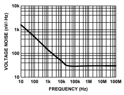
FIGURE 13. VOLTAGE NOISE vs FREQUENCY - VIDEO AMP
