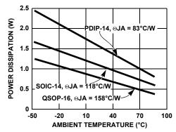
FIGURE 47. MAXIMUM POWER DISSIPATION vs AMBIENT TEMPERATURE QUADS (T<sub>JMAX</sub> = +150°C)
