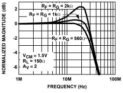
FIGURE 9. FREQUENCY RESPONSE FOR VARIOUS  $\rm R_F$  and  $\rm R_G$
