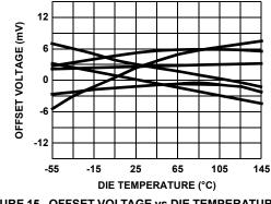
FIGURE 15. OFFSET VOLTAGE vs DIE TEMPERATURE (6 TYPICAL SAMPLES)
