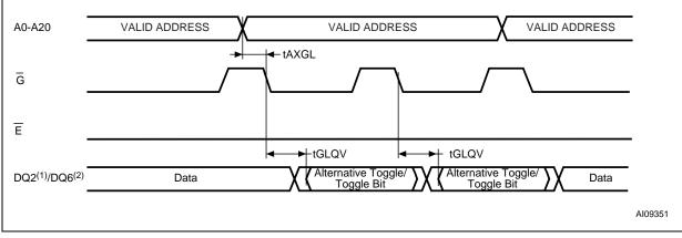
1. The Toggle bit is output on DQ6.
