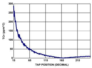
FIGURE 13. 10k TCv vs TAP POSITION
