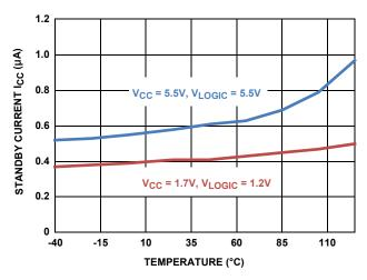
FIGURE 24. STANDBY CURRENT vs TEMPERATURE
