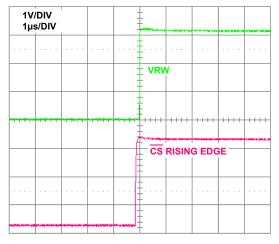
FIGURE 21. WIPER LARGE SIGNAL SETTLING TIME
