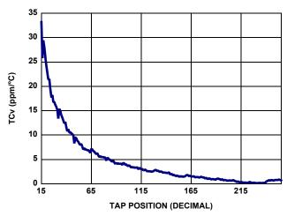
FIGURE 17. 100k TCv vs TAP POSITION
