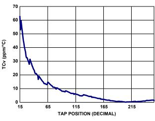
FIGURE 14. 50k TCv vs TAP POSITION
