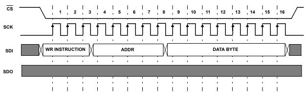
FIGURE 27. TWO BYTE WRITE SEQUENCE
