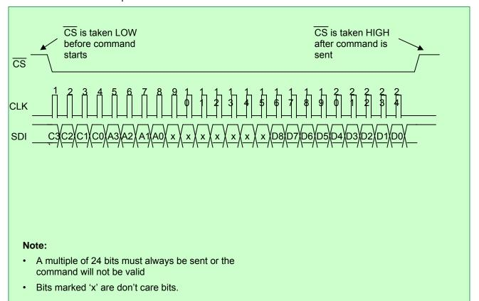
FIGURE 5 - SPI COMMAND WAVEFORMS
