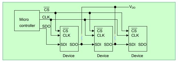
FIGURE 3 – DAISY CHAIN CONFIGURATION [10-PIN TSSOP PACKAGE ONLY]
