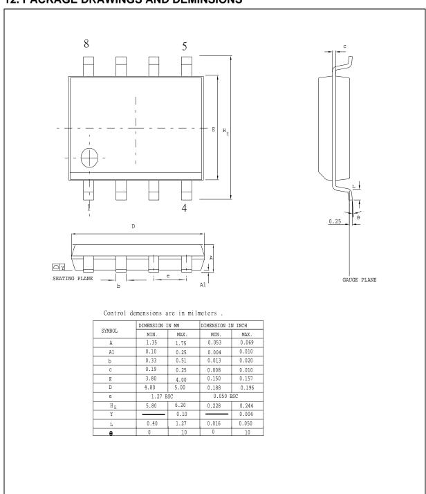
FIGURE 13 - 8L SOIC - 150MIL
