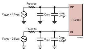
Figure 13. An RC Network at IN<sup>+</sup> and IN<sup>-</sup>
